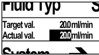
Fig. 42: Inputting the calibration actual value
