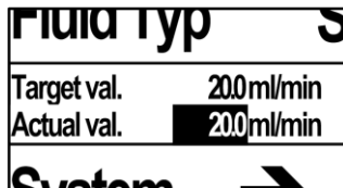
Fig. 44: Inputting the calibration actual value
